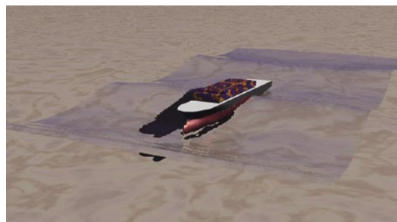
図-3 CIP 法による波浪中船体運動の計算例
