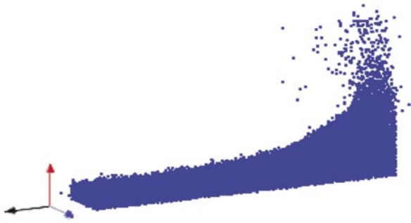
図-2 粒子法によるスロッシングの計算例
