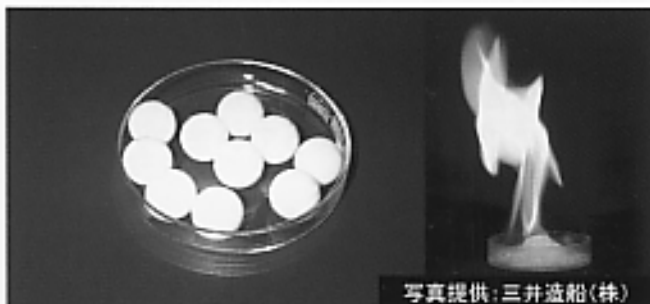
写真1 メタンハイドレートベレット(左) ハイドレートパウダーが燃える様子(右) (提供 三井造船(株))
