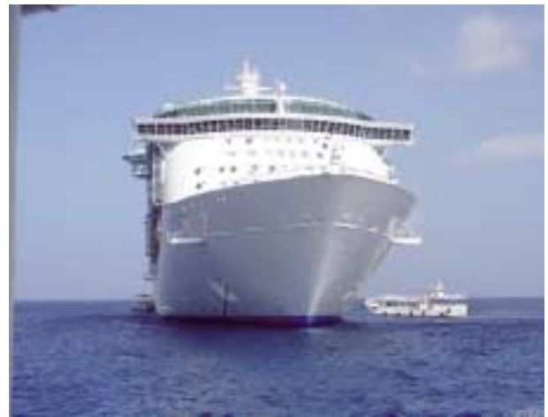
写真4 沖止めで安全にテンダーボートへの乗下船のためにポッド推進器を活用する「フリーダム・オブ・ザ・シーズ」
