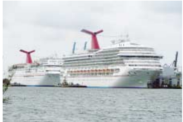
写真3 カーニバルは7万総トン型クルーズ客船8隻を連続建造した後、10万総トン型9隻を連続建造しました。7万総トンの最後の2隻はポッド推進器、10万総トン型船も「カーニバル・トライアンフ」(右)にはポッド推進器が採用されました。写真左は、初期の7万総トン型の1隻の「イマジネーション」で、在来型ディーゼル電気推進で可変ピッチプロペラを回しています。
