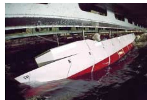
図6 大型コンテナ船の正面向波中試験（当所中水槽）
