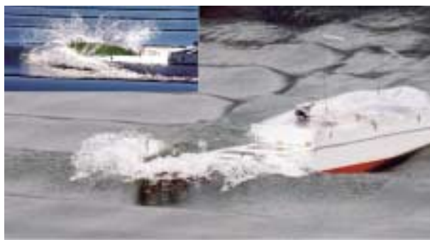
図2 ポストパナマックス・コンテナ船模型を用いた大波高中での水槽試験
