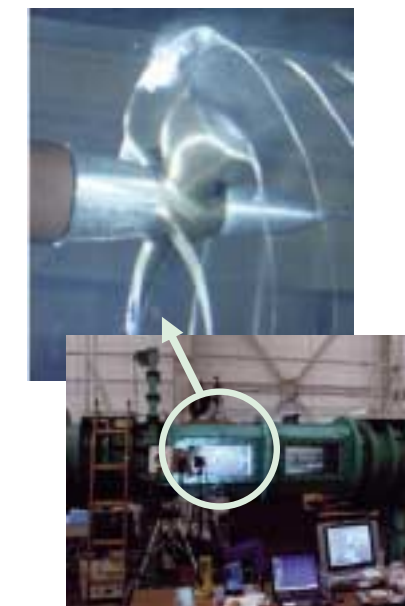
図4 大型キャビテーションタンクでキャビテーション損傷の迅速試験を実施中の模型溶射プロペラ
