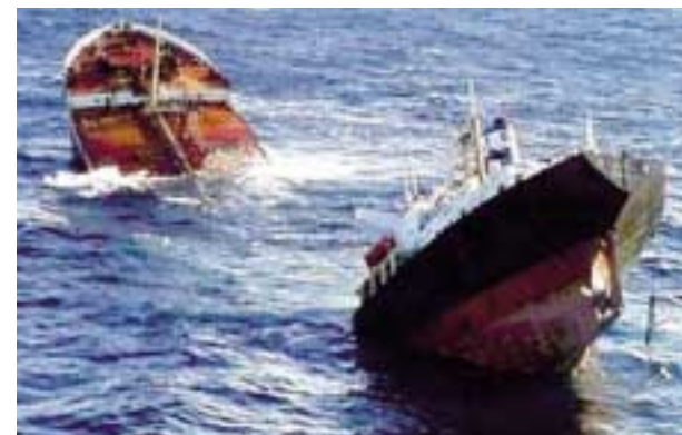
図1 プレステジ号折損事故（2002年） （事故報告書より）
