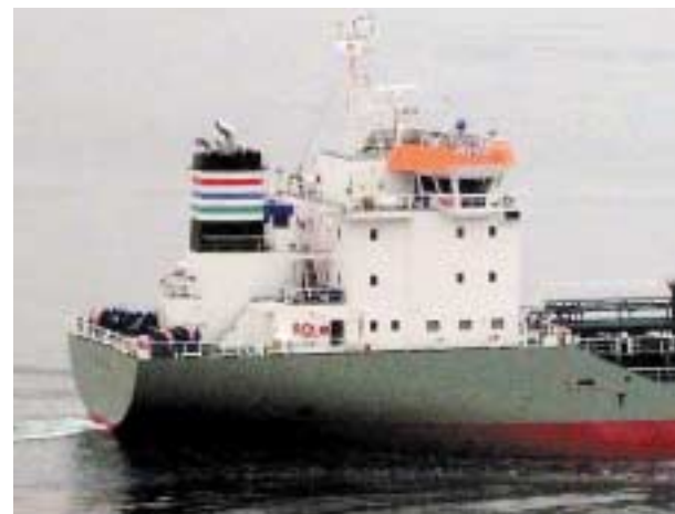
図6 エンジンケーシングと完全にセパレートされた居住区域
