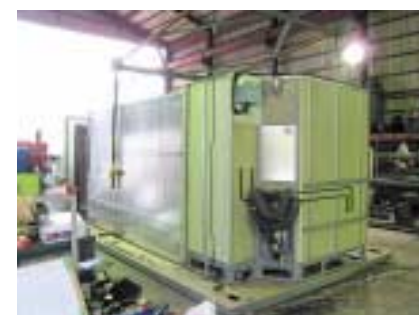
図7 陸上で組み立て中の居住区ユニット
