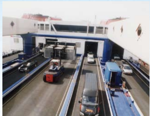
写真4 4つのドアから車両を荷役。中央では食材・商品を積載したコンテナが荷役されている。
