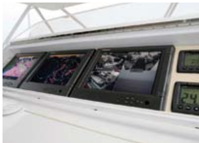
写真2 61フィートの大型艇ブリッジ。最新の航海電子機器「NavNet 3D」の大型モニターが3式埋め込まれている。
