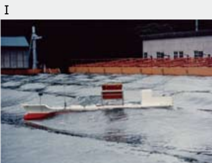
I 波の下り斜面で、右舷斜め後ろから追波を受け、波向きに垂直にしようと、左に舵をきる。
