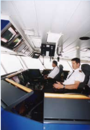
写真2 コンパクトなコック ピット型ブリッジ
