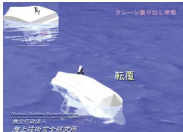
事故解析結果に基づくほたて漁船の転覆事故発生状況の再現CG
