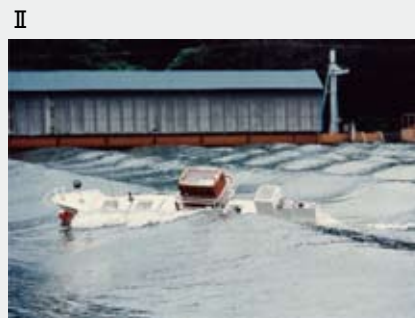
II 大きな波の力により舵が効かなくなり、右に回頭しながら、滑るように流されてしまう。
