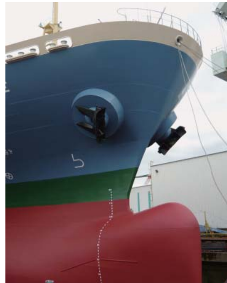
写真2 船首部形状（ノーズアップタイプのバルバス・パウ）
