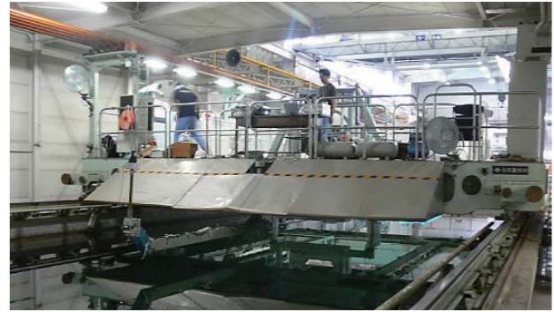
図4 曳航水槽におけるVIV流体力計測
