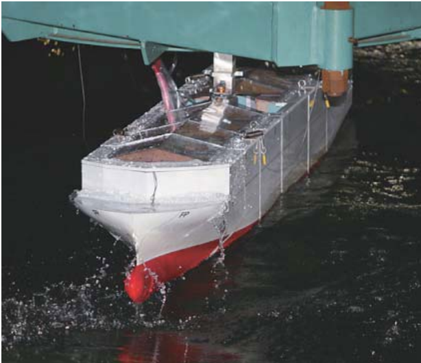
写真4 最新式バックボーン模型を用いた水槽実験 (海上技術安全研究所海洋水槽)
