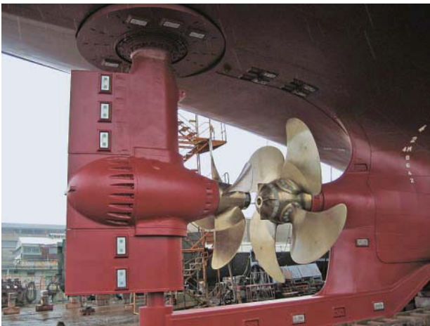
写真5. 二重反転推進装置
