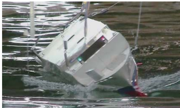
荷崩れを起こし第二波目で傾斜した状態(40度程度)
