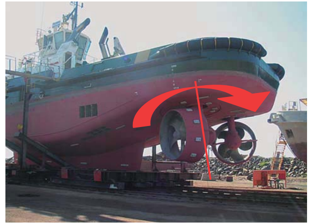
写真1. Zペラ搭載タグの船尾部
