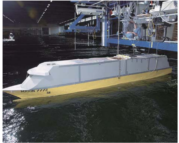
写真3 海上技術安全研究所がオランダMARINと共同実施した復原性試験(大型客船の横風横波中での復原性試験)
