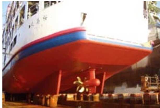
写真2 2重反転PODと2枚スケグ付の船尾
