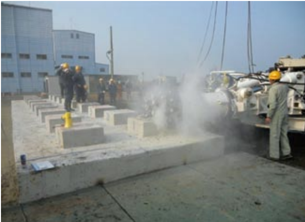
図 11. 採掘要素技術試験機の性能試験の様子 (左：陸上掘削試験（於：三井三池製作所 九州事業所）、右：水中掘削試験（於：落下水槽））
