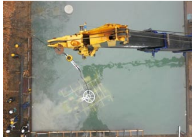
図 11. 採掘要素技術試験機の性能試験の様子 (左：陸上掘削試験（於：三井三池製作所 九州事業所）、右：水中掘削試験（於：落下水槽））
