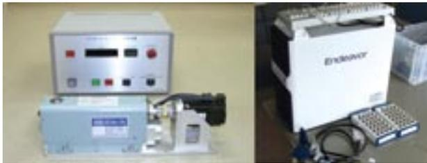
図 2 自航動力計一体型駆動モーターと演算機(+入出力機器)
