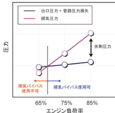
図5 掃気バイパスの使用可能条件例
