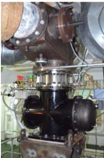
図6 実船搭載された排熱回収スターリングエンジン
