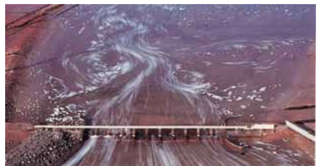
図3 水路実験研究所、河水制御模型実験
