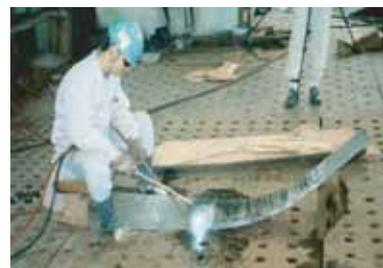
図-1 熱絞り作業（鞍型板）
