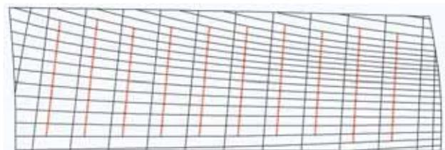
図-4 鞍型板のプレス線（横方向の黒線）と熱絞り施工線（赤線）
