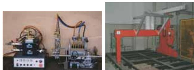
図-5 ぎょう鉄簡易自動機（左）と3次元形状計測装置
