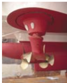
図3 POD型推進装置(ショッテルSTP330)
