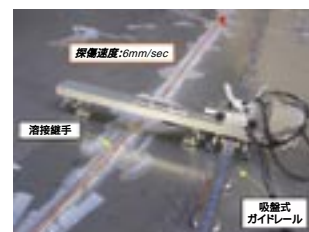
図4．超音波探傷装置「蟹太郎」の適用状況
