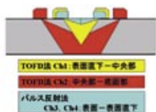
図6. 各探触子の配置とその探傷範囲
