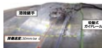
図7. 自動超音波探傷装置「富々蔵」適用状況
