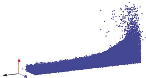
図-2 粒子法によるスロッシングの計算例
