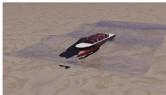
図-3 CIP 法による波浪中船体運動の計算例
