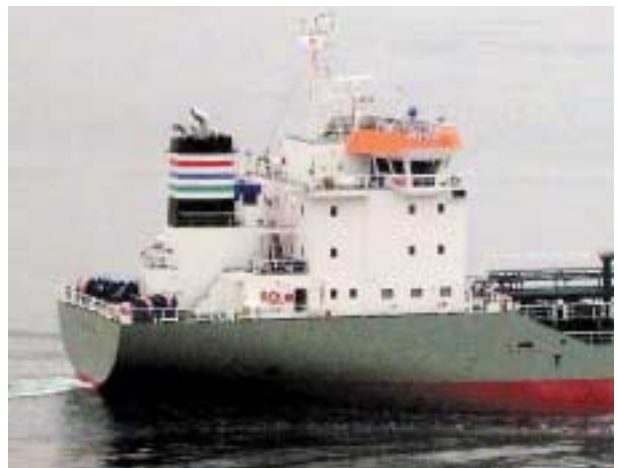
図6 エンジンケーシングと完全にセパレートされた居住区域
