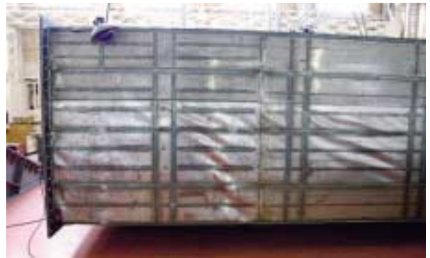
(1) 崩壊試験結果（船側外板）
