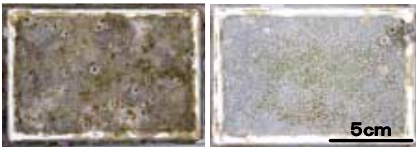
図2 コーティングへのフジツボの付着 左：アルミニウム80%銅（5ヶ月間） 右：亜鉛（7ヶ月間）
