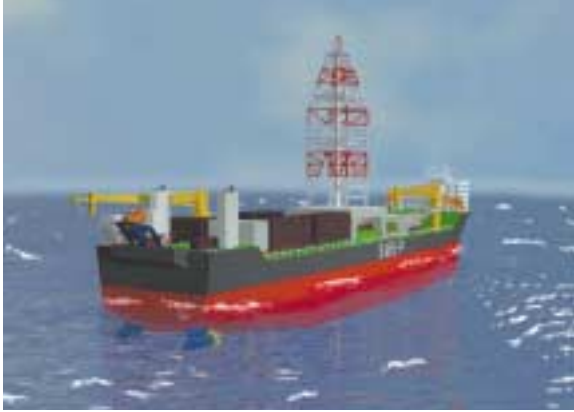
図5 熱水鉱床開発用プラットフォームイメージ（強潮流対応のため船尾にポッドスタスター2基、船首にアジマススタスター3基を装備）
