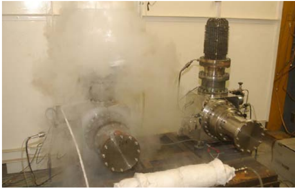
写真3 運転時の冷熱利用スターリングエンジン
