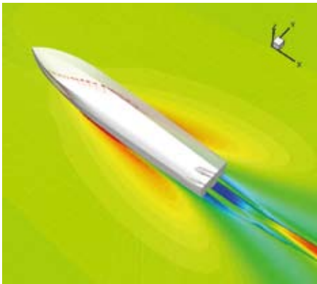
図7 ウォータージェット船の自由表面計算
