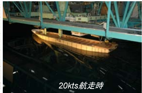
水槽実験用に制作したリアクションポッド模型
