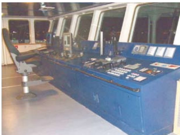
写真8 NOORDHOEK CONSTRUCTOR (操舵室)
