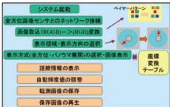
図4 海上監視・情報提供システムの機能概要
