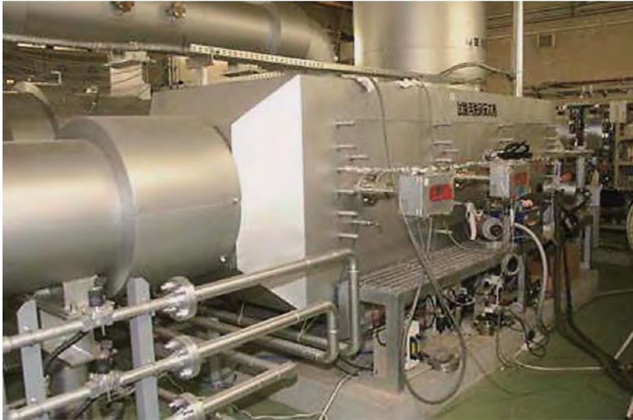
試験用SCR脱硝装置
