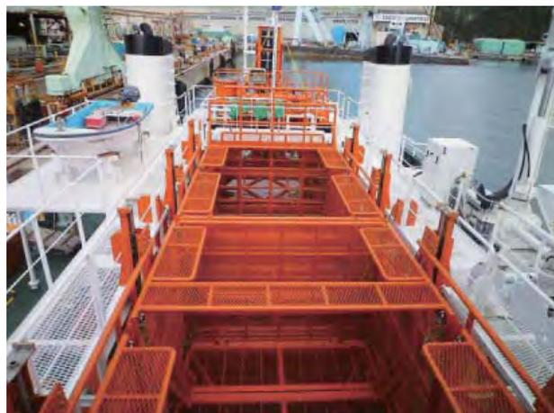
写真2 コンテナ昇降式ゴミ回収装置
