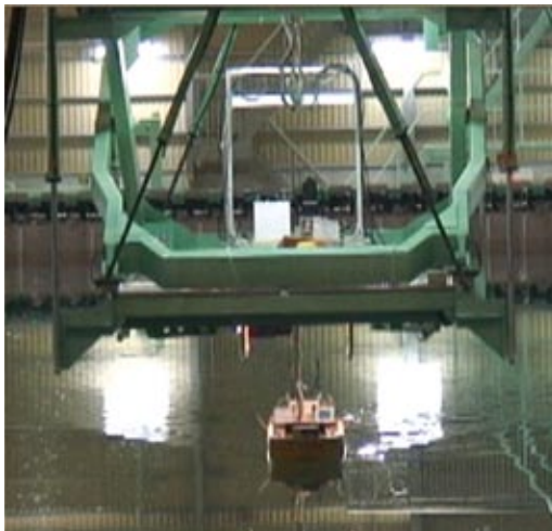
図2 肥大船の自由航走実験の様子
