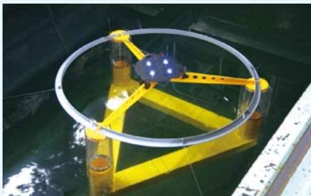
セミサブ型のマルチコラム浮体模型
