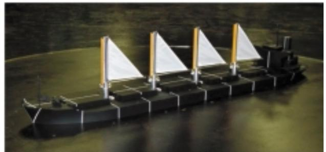
次世代型帆装船の風洞実験
