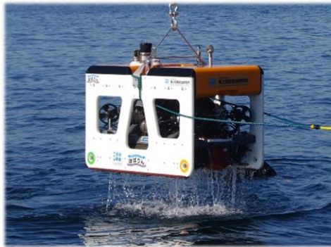
図 6c. ホバリング型 AUV 「ほぼりん」
