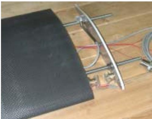
図 1 CFRP 製軽量能動制御翼外観
