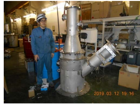
図5 設計・試作した小型SO x スクラバ
