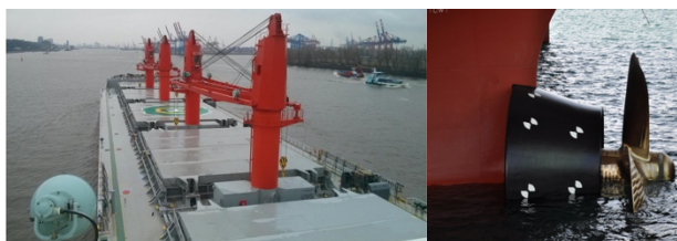
図-1 供試船型(左)および船尾ダクト(右)の概要
