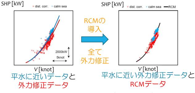
RCMをベースに用いた 実運航シミュレーションと計測の比較 (1航海当たり)
