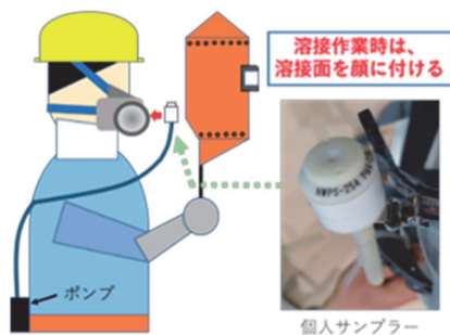
図-2 個人サンプラーでの溶接ヒュームの計測
