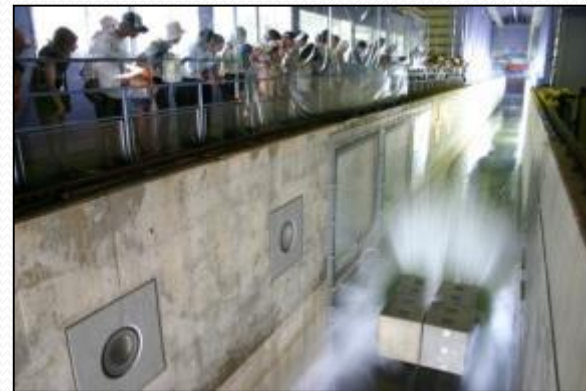
大規模波動地盤総合水路
