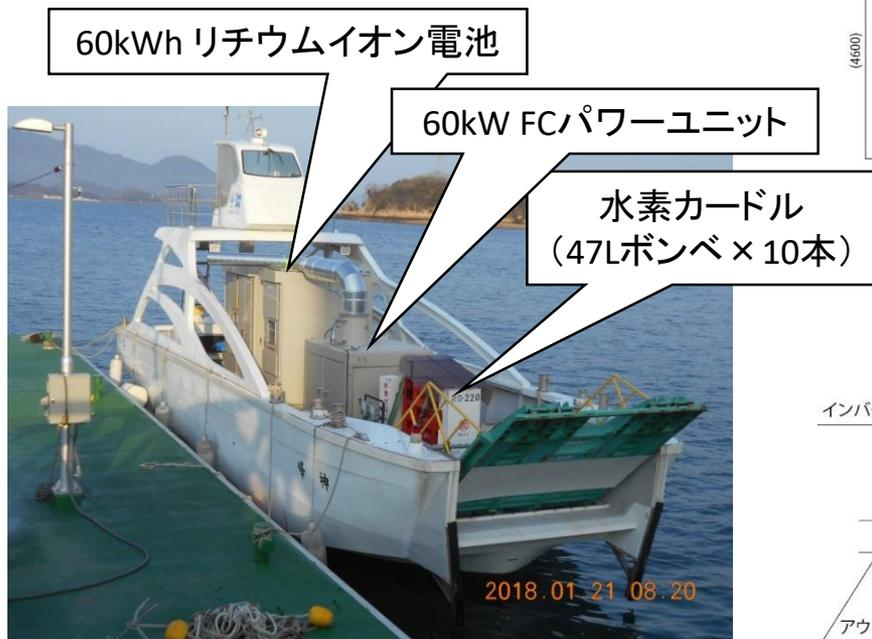
船用燃料電池推進システムを搭載した
