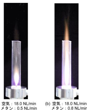
図-4 熱平衡プラズマジェットを用いた希薄予混合ガスの着火・支援燃焼写真
