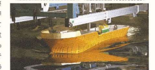
波浪中で航行する船舶に働く非定常圧力分布の計測実験
