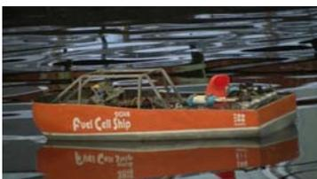
模型燃料電池船の水槽試験
