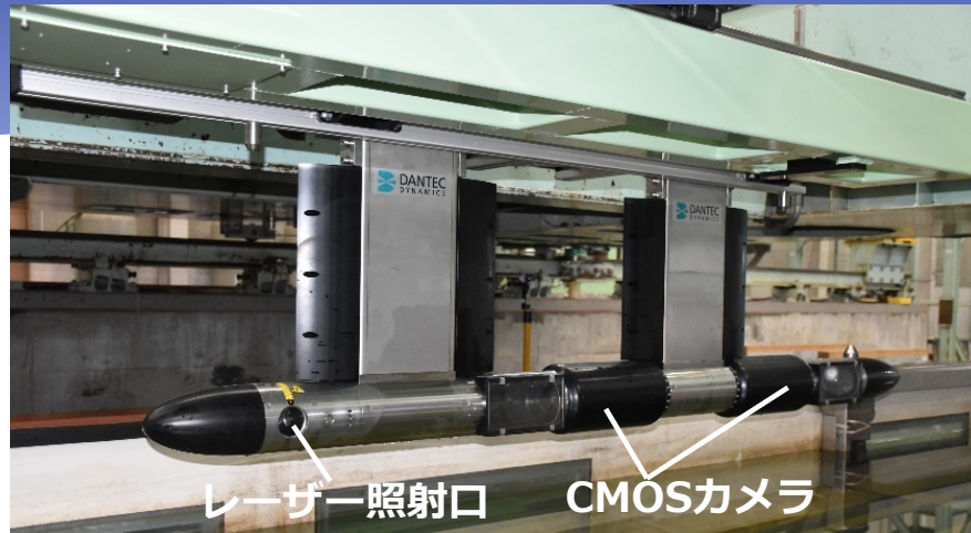
図 曳航水槽用ステレオPIV計測装置
