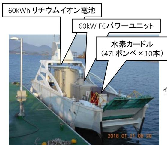
船用燃料電池推進システムを搭載した
