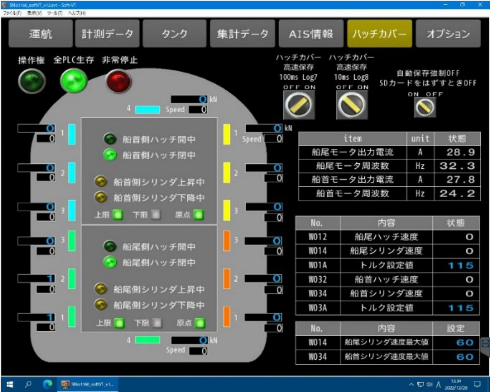
電動ハッチカバーの監視画面
