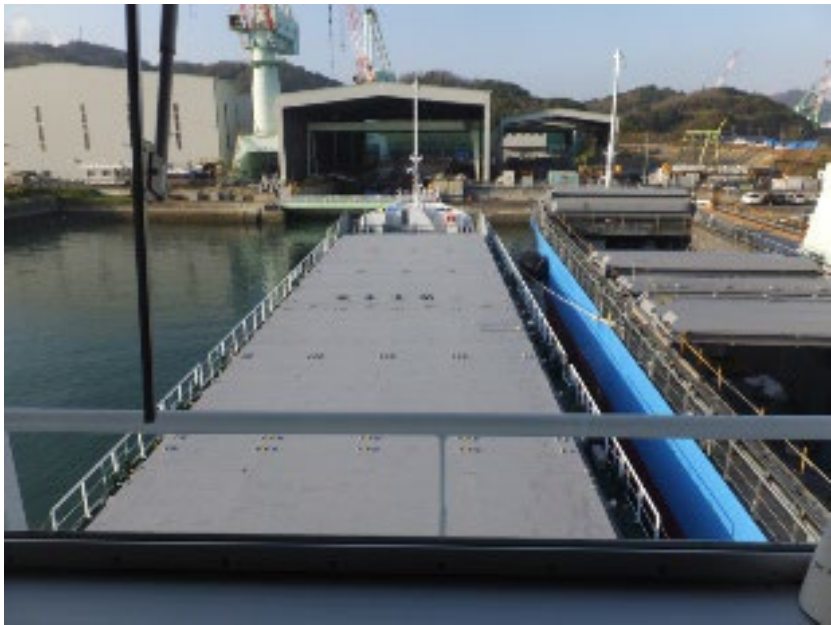
鉄鋼運搬船と電動ハッチカバーの外観
