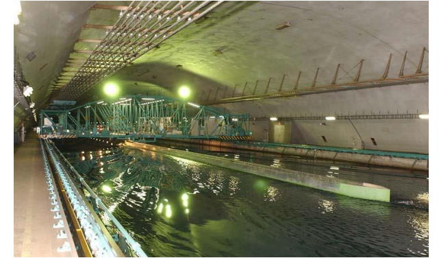
海技研400m水槽 50m長尺平板模型試験
