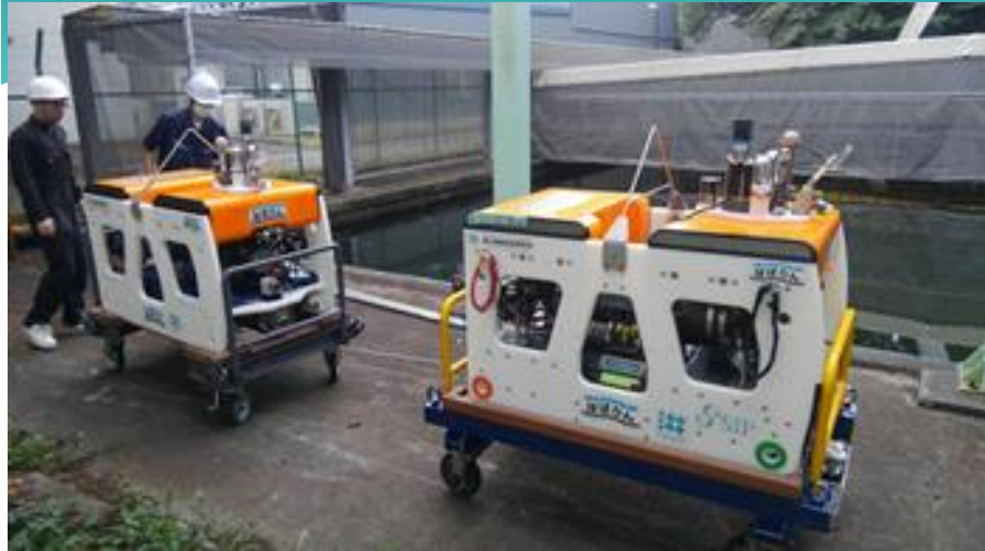
試験に使用した2機のホバリング型AUV ほばりん (左) ・ほばりん2 (右)
