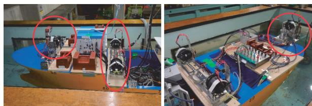
図-1 風荷重模擬装置の設置例 (左: 船首部, 右: 船尾部)
