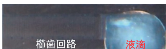
図-2 試作した音響流放射型流場制御デバイス
