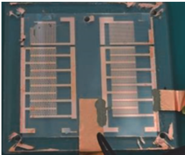
図-2 試作した音響流放射型流場制御デバイス
