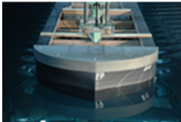
船首造波の状況 (計画満載状態, 設計船速V s =10knot)
