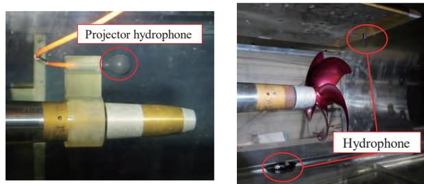
図-1 伝達関数計測時及び模型プロペラの写真
