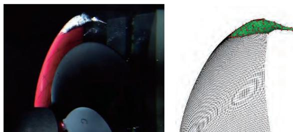
図-5 キャビティ形状計測結果(プロペラ位相角 50[deg])
