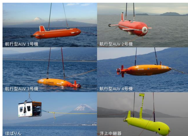
図-2 海技研が開発した AUV と洋上中継器 (ASV)
