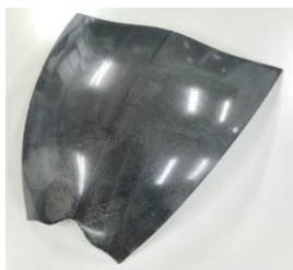
図-5 VaRTM法による成形結果
