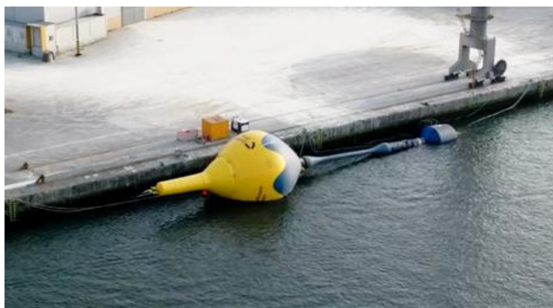
波力発電の実証機 (CorPower、ポルトガル)
