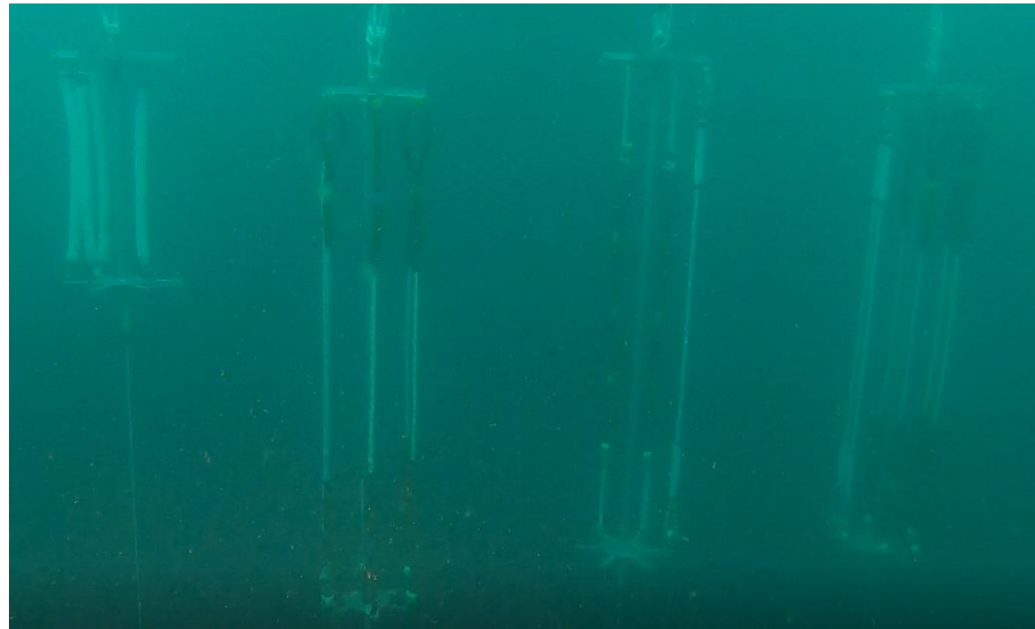
実海域における合成繊維索試験体の浸漬試験の様子 (左図：北海道 中図：静岡県 右図：高知県)
