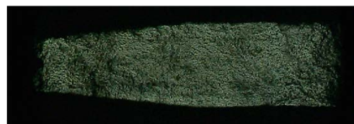
メタン雰囲気中の噴霧の着火・燃焼(撮影例) デュアルフューエルエンジン
