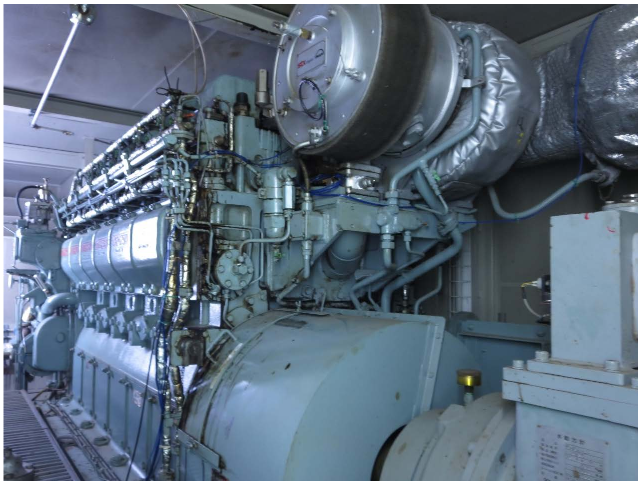
NH 3 と混焼を実施した船用中速ディーゼル機関 (750kW、1000min -1 )
