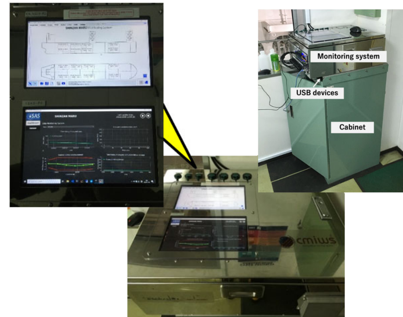
就航船の搭載したi-SAS (L=約320mの鉱石運搬船で検証中)
